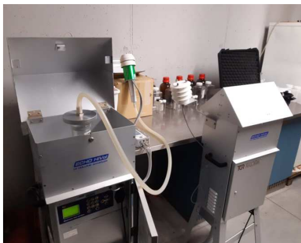
Figura 10 – Campionatori ad alto volume per la determinazione di PCDD, PCDF e PCB-DL e dettaglio della testa di campionamento
