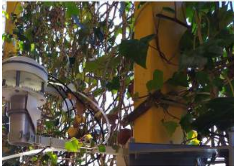
Sensori disposti a livello di parete verde sia davanti che dietro la coltre vegetale
